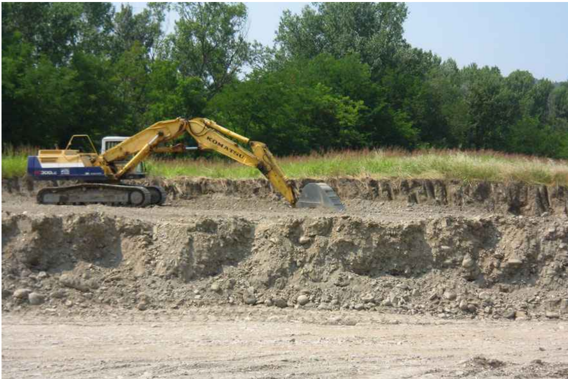
Rivabella (1 luglio 2010): il fotogramma mostra in primo piano la porzione di lotto in cui la coltivazione di ghiaie e sabbie è iniziata partendo dal settore orientale per procedere verso W per mandate orizzontali piano - parallele discendenti di circa 3 m di spessore, al centro è visibile il tetto del giacimento utile (su cui poggia l'escavatore) già decorticato del suolo pedogenizzato e del cappellaccio, il cui modesto spessore è visibile dietro il mezzo d'opera.
