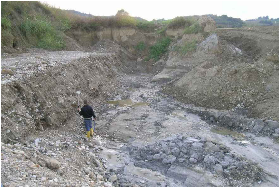
Rivabella (1 ottobre 2010): un momento del rilievo topografico eseguito per determinare le quote di fondo scavo; in questo fotogramma sono ben visibili le tre stratificazioni costituenti i terreni di comparto: l'argilla azzurra di substrato, lo strato di giacimento ghiaio-sabbioso utile e, al tetto della sequenza, il cappellaccio limo-argilloso sovrastato dal suolo pedogenizzato.
